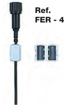
Ferrite de protection. Aide à la protection CEM par atténuation des parasites haute fréquence. Utilisation sur câble coaxiaux et cordons laboratoires de Ø 3,5 à Ø 5 mm. Application : informatique, appareils de mesure, alimentation,... Montage instantané, sans outil, même sur câbles ou cordons déjà installés. Impédances de 101 Ω à 25 MHz et 144 Ω à 100 MHz. Matériaux PA6 (UL94 VO et CEI 60707 VO) et ferrite nickel-zinc.
