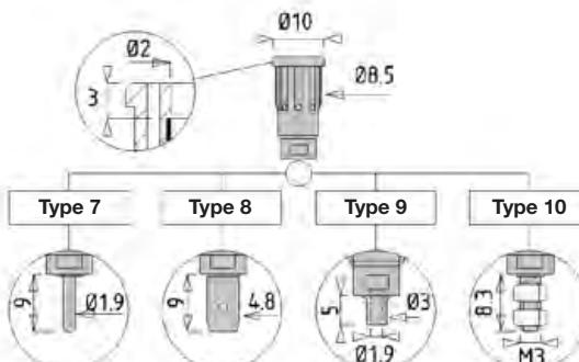
**Drilling - Perçage - Bohrung**
